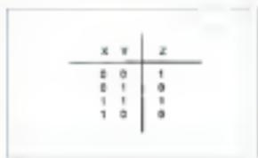
Figura 3 - Una tabella di verità di una rete combinatoria con due ingressi ed una uscita.
